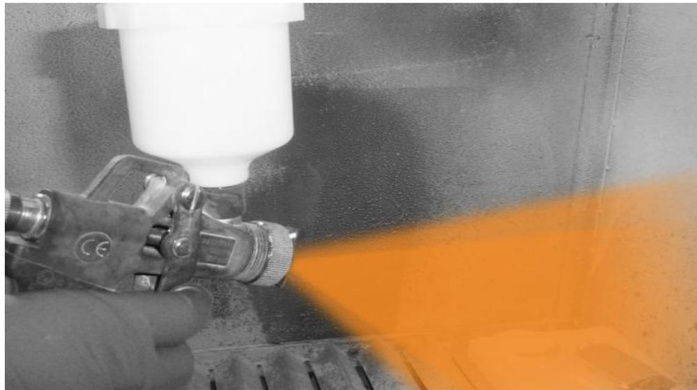
Schichten  $<1\mu\text{m}$  verbessern die Kratzbeständigkeit oder das Benetzungsverhalten. Schichten  $>10\mu\text{m}$  wirken elektrisch isolierend. Nach Ihrem Anforderungsprofil entwickeln wir die für Ihre Anwendung passende Beschichtung.
